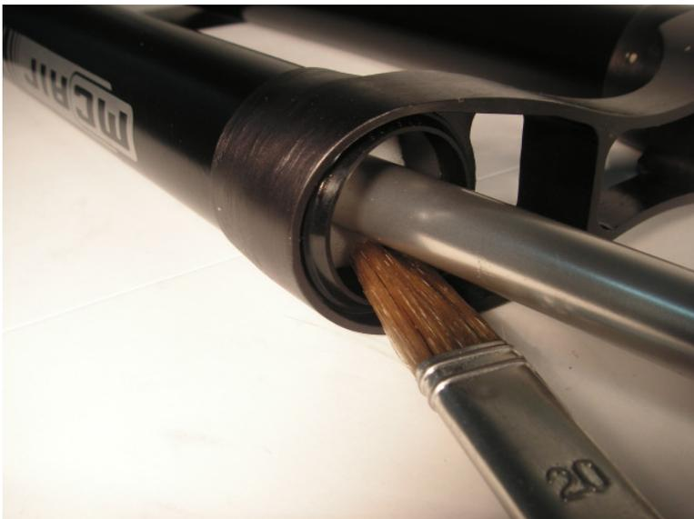
**Da mit dem Einstecken der Luftfilter auch Fett von den Gleitlagern abgestreift wird, sollte oberhalb der Luftfilter nochmals nachgefettet werden.**
