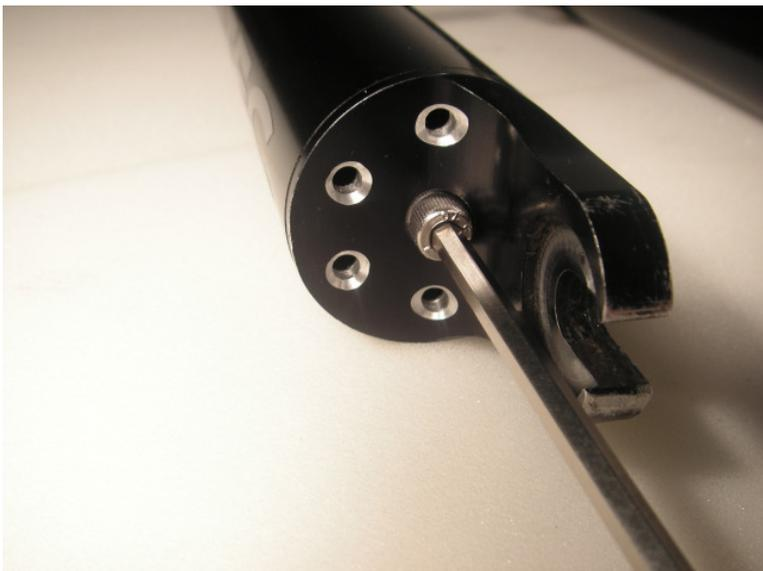
**Zuletzt werden die Kolbenstangen im AE mit einer Inbusschraube 5x12 mit 4-6Nm befestigt.**
