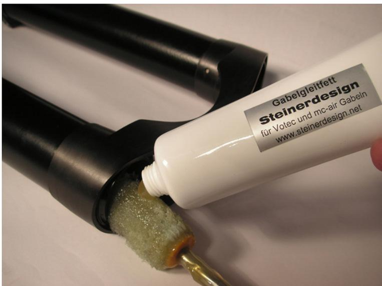
Gleitlager, Distanzen und die DAS nach entsprechender Vorlage wieder einsetzen und anschließend einfetten.
