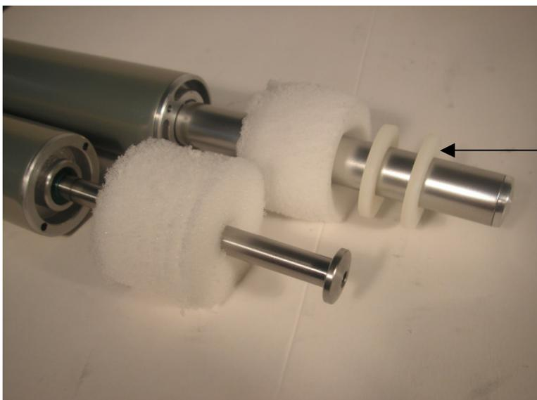
Die Luftfilter werden auf die Kolbenstangen aufgeschoben
