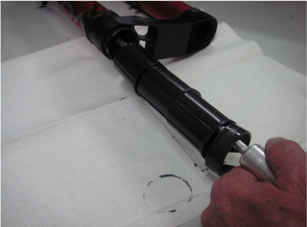
Zunächst sollten die Führungen, Distanzen und Endanschlaggummis aus dem GU entfernt werden, so dass das GU innen von Schmutz und Fett gesäubert werden kann.
